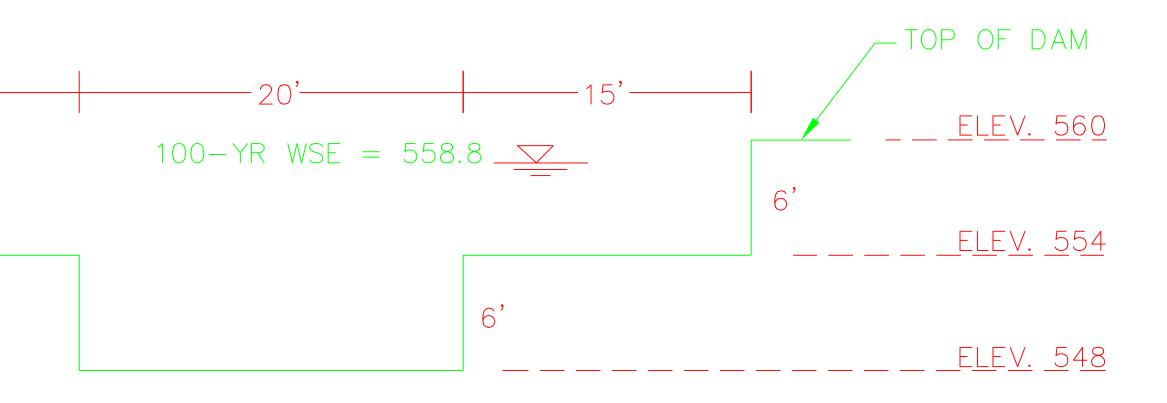
OUTFALL CONTROL WEIR CONFIGURATION N.T.S.
